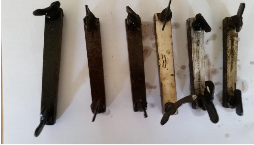
Fig. 11 moldes para palhetas de (esquerda para direita) sax barítono, sax alto, sax alto, sax tenor, sax soprano e clarineta.
