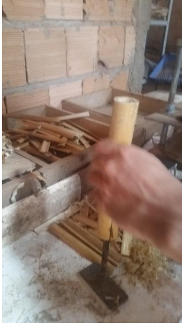
Fig. 4 Posição para corte do Arundo
