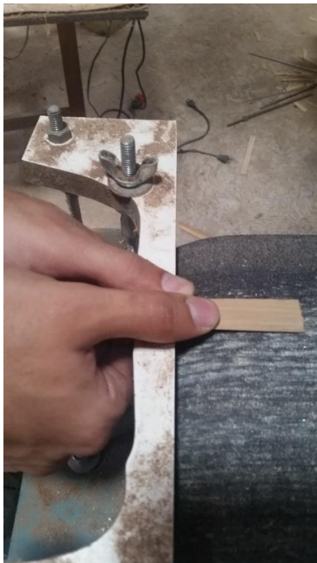
Fig. 15 fazendo o corte redondo da palheta.
