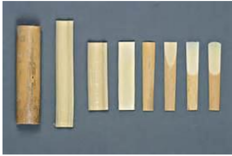
Fig. 8 Processos para a fabricação das palhetas simples.
