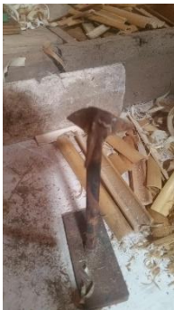
Fig. 3 Tridente para corte dos tubos de Arundo .
