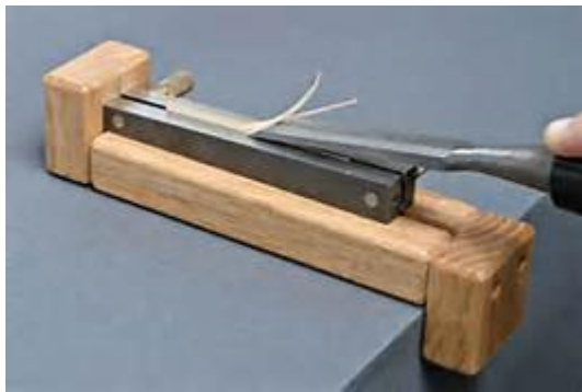
Fig. 9 plainando o Arundo manualmente .
