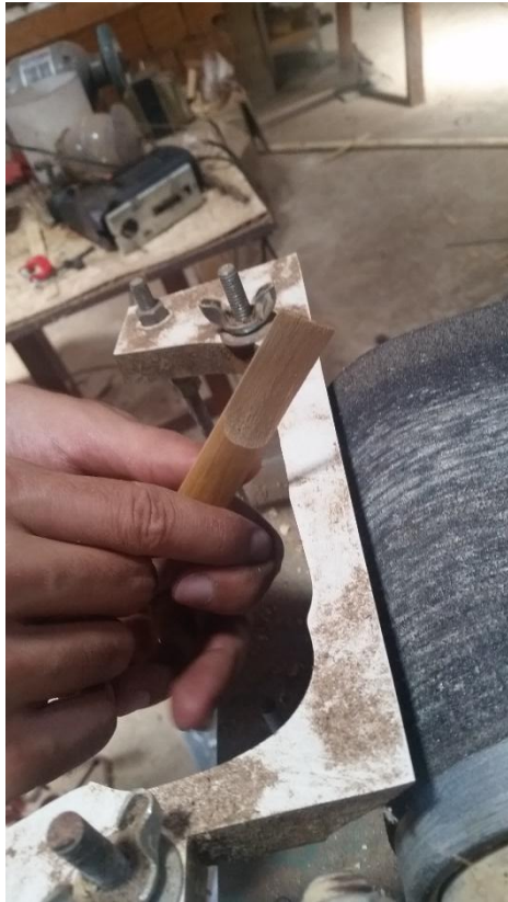
Fig. 16 Corte redondo da palheta
