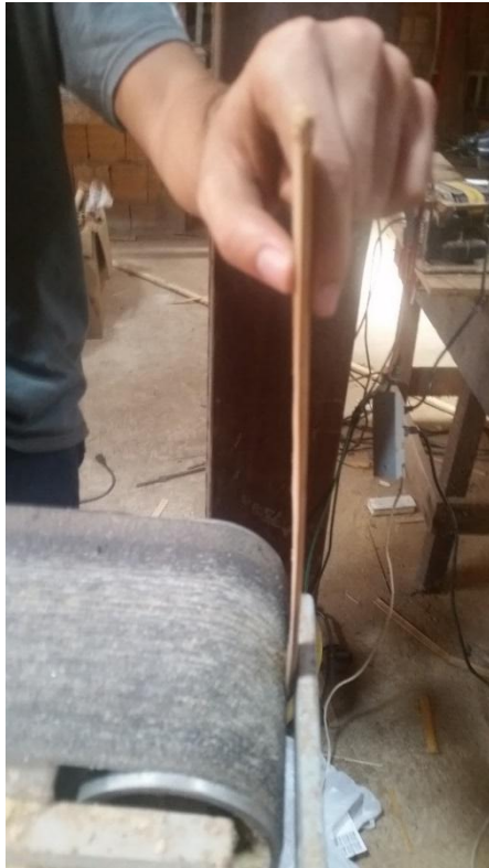
Fig. 10 Lixamento do Arundo utilizando lixadeira semi-industrial
