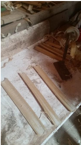
Fig. 5 Arundo cortado em filetes
