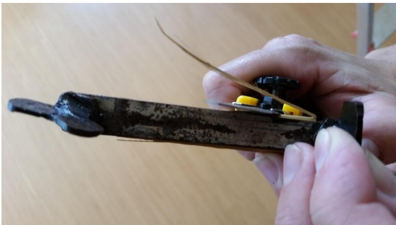
Fig. 13 Moldando o Arundo donax com a utilização de um estilete.
